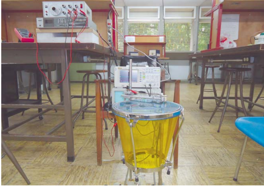
FIGURA 4. Montaje experimental para las figuras de Chladni en una caja vallenata
