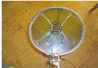
FIGURA 6. de Chladni del modo 21, \omega = 701\text{Hz}
