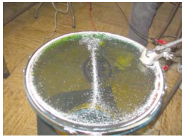
FIGURA 5. Figura de Chladni del modo 11, \omega = 491\text{Hz}
